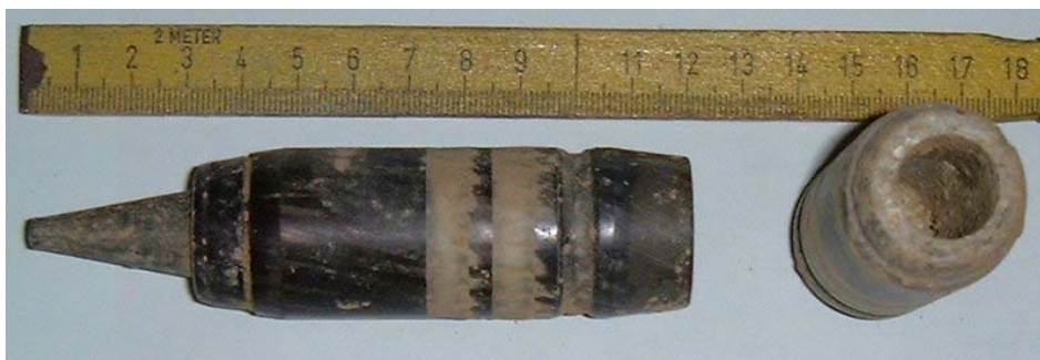
Abb. 1: DU - Munition (GAU-8/A, 30 mm) / DU - Masse rund 300 g (Quelle: HFüKdo, G 3 Eins) Durchmesser 3 cm , Länge ohne Kappe 12 cm , Urankern: Durchmesser 1,5 cm , Bohrung Tiefe 6,5 cm , Länge 9,5 cm , Gewicht des Projektils: mit/ohne Kern 415 g/118 g
